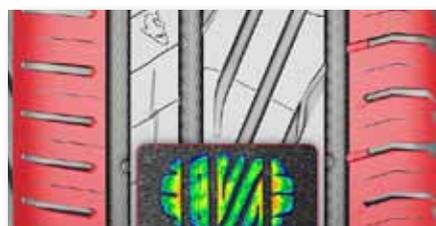
Der Uniroyal RainSport 5 verfügt über eine neuentwickelte Reifenmischung mit einer geringeren Abnutzungsrate. Die verbesserte Steifigkeit im Schulterbereich sorgt für optimierte Blockbewegung und weniger Profilverschleiß. Das optimierte Profildesign führt zu gleichmäßigem Auflagedruck für eine optimierte Laufleistung und Geräuschperformance.
