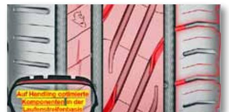
Im Uniroyal RainSport 5 unterstützt eine optimierte Laufstreifenbasis das Handling auf trockenen Straßen. Zusätzlich gewährleistet die verstärkte Zwillingsblockstruktur an der Außenschulter eine präzise Kraftübertragung und Seitenführung. Breite und feste Mittelrippen sorgen für exzellente Fahrstabilität und perfekten Geradeauslauf.
