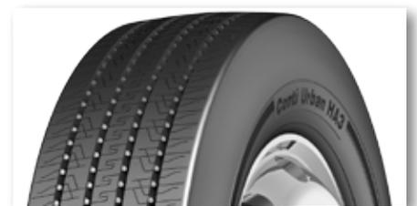
Mit spezieller Laufflächenmischung, optimiertem Positivanteil im Profil sowie einer um 20 Prozent erhöhten Seitenwandstärke erreicht der Conti Urban HA3 bis zu 20 Prozent mehr Laufleistung und verbessert die Reichweite. In ausgewählten Größen trägt er bis zu acht Tonnen pro Achse und wird damit den Anforderungen von Elektrobussen gerecht.
