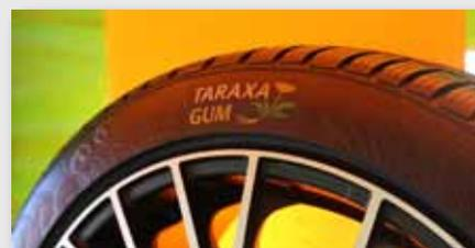
Versuchsreifen mit Taraxagum-Technologie sind bereits im Einsatz.
