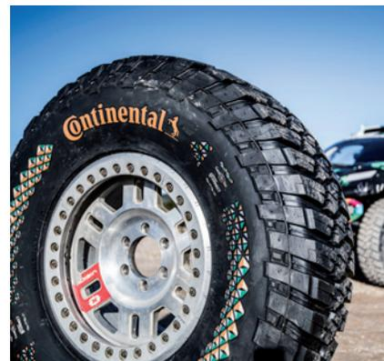
Neueste Technologien für mehr Nachhaltigkeit: Die zweite Reifengeneration für die Extreme-E-Rennserie besteht bereits zu rund einem Drittel aus recycelten und erneuerbaren Rohstoffen.
