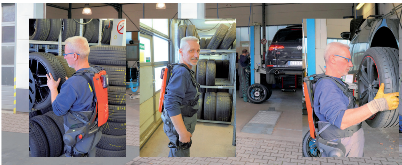
Ein Exoskelett unterstützt im Werkstattalltag von Reifen-Müller aktiv beim Montieren und Demontieren von schweren Reifen und Komplettträgern.
