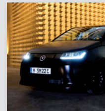
Vorserienfahrzeug, bestückt mit 456 Solar-Halbzellen.
