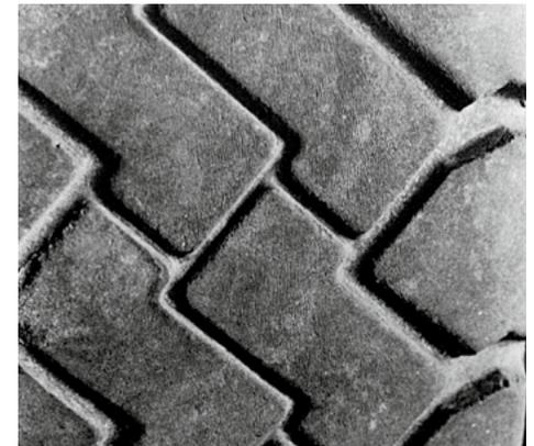
**Schienenförmiger Verschleiß (Freilaufrillen)****Ursache**
