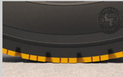
Das Zweiphasenprofil von Continental ist, als ob zwei Reifen in einem integriert wären. Die Profilstruktur ändert sich von einer offeneren Struktur für eine sicherere Haftung zu einem geschlossenen Profil, das für einen geringen Rollwiderstand mit ebenso guter Haftung auf der Fahrbahnoberfläche optimiert ist. Wenn das Winterprofil abgenutzt ist, verbleibt ein Reifen für Lenk- und Trailerachsen mit sehr guten Verbrauchswerten für die Sommersaison.
