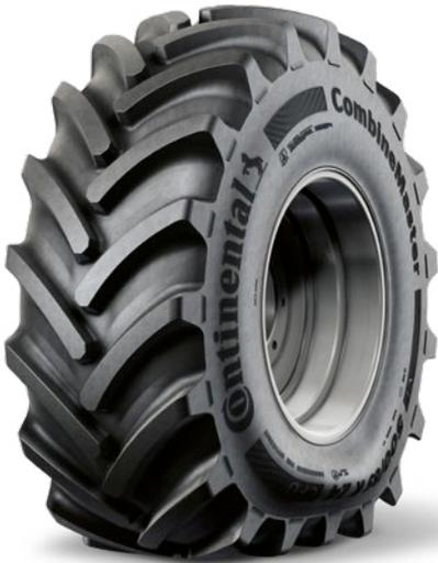
Der VF CombineMaster kann bei geringem Luftdruck sowohl auf dem Feld als auch auf der Straße eingesetzt werden, ohne den Luftdruck anzupassen. Die Faustregel für für VF-Reifen lautet: 40 % mehr Last oder 40 % weniger Reifendruck bei gleicher Last.
