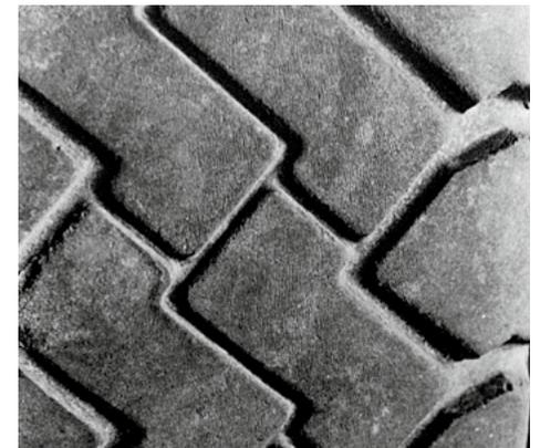
**Schienenförmiger Verschleiß (Freilaufrillen)****Ursache**
