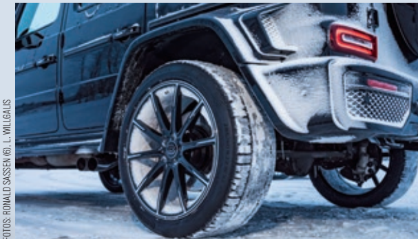
Normal trägt dieser Sonder-G fette 23 Zöller und 305er-Reifen. Für den Wintertest wurden Monoblock-Räder in 22 Zoll und Conti Winter Contact TS 850 P in 285/40 R22 montiert
