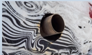
Tarnfolie, weil die mittig endende Sportauspuffanlage samt passender Heckschürze noch in der Erprobung war
